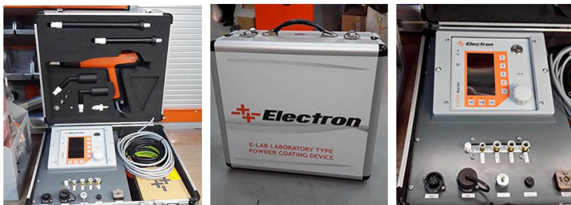
Прибор оснащен функцией памяти 50 формул и функцией триггера, обеспечивающей переход между цветами. Благодаря функции дистанционного подключения, он обеспечивает внешнее вмешательство и возможность попробовать нанести разные типы краски.
