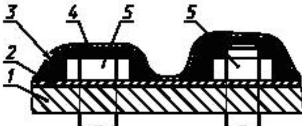
1 — деталь из магниевого сплава; 2 — лакокрасочное покрытие; 3 — слой герметика или шпаклевки П-5; 4 — слой эмали (окончательная окраска); 5 — алюминиевый или стальной кадмированый болт или гайка (болты поставляются на сыром грунте)
