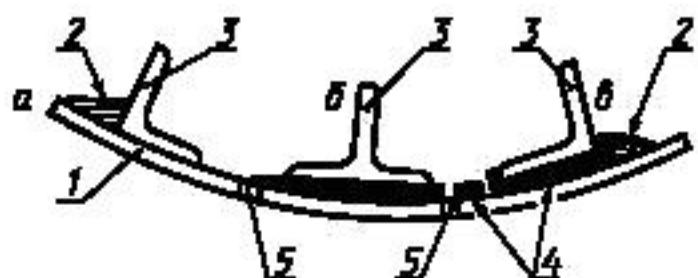
*a* — неудачное соединение (электролит замыкает место контакта); *b, в* — удачное соединение (дренажные отверстия и изолирующая прокладка препятствуют соприкосновению детали с электролитом); 1 — ошибка из алюминиевого сплава; 2 — электролит; 3 — кронштейн из магниевых сплавов; 4 — прокладки; 5 — дренажные отверстия
