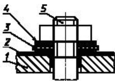
1 — деталь из магниевого сплава; 2 — лакокрасочное покрытие; 3 — слой герметика; 4 — шайба-прокладка; 5 — алюминиевый или титановый болт (поставлен на грунте)
