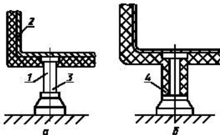
а — неудачное решение; б — более удачное решение; 1 — место образования конденсата; 2 — металлический корпус резервуара (источник тепла); 3 — металлическая опора; 4 — изоляция опоры
