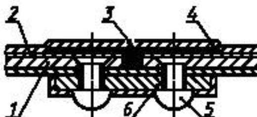
1 — магниевый сплав; 2 — лакокрасочное покрытие; 3 — слой шпаклевки; 4 — слой эмали (окончательная окраска); 5 — заклепки алюминиевые (сплав АМг5); 6 — грунт
