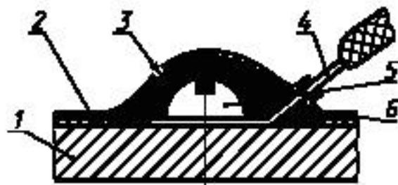
1 — деталь из магниевого сплава; 2 — лакокрасочное покрытие; 3 — слой герметика или шпаклевки П-5; 4 — клемма металлизации; 5 — винт крепления металлизации; 6 — слой эмали (окончательная окраска)
