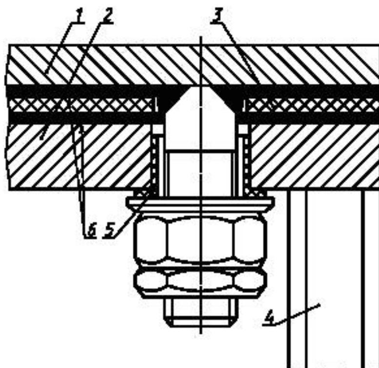
1 — стальная платформа; 2 — соединительный фланец из алюминиевого или титанового сплава; 3 — изоляционная прокладка из листового винилпластика марки ВН; 4 — корпус; 5 — втулка из стеклопластика АГ-4С; 6 — уплотнительные прокладки
