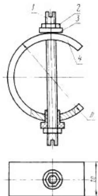
1—стяжная шпилька из сплава титано, стали марки 12X18H9T; 2—гайка из сплава титана или стали марки 12X18H9T; 3—прокладка текстолитовая; 4—образец кольцевой.
