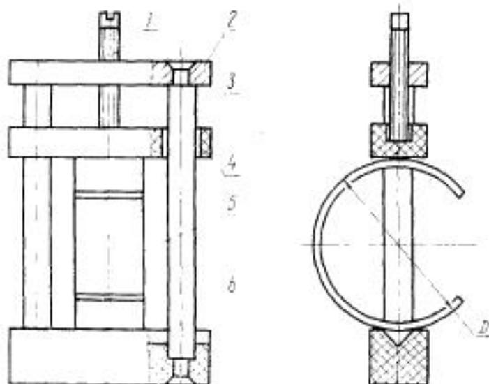
1—нажимной винт из сплава титана или стали марки 12X18H9T; 2—верхняя переkladня из сплава титана или стали марки 12X18H9T; 3—направляющая из сплава титана или стали марки 12X18H9T; 4—подвижная перекладня текстолитовая; 5—образец кольцевой; 6—нижняя перекладня текстолитовая.
