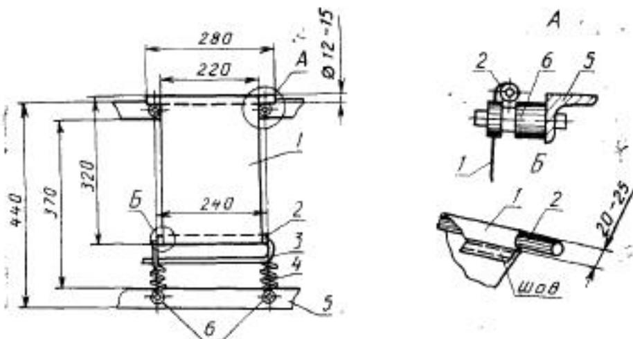
1 — сухое полотно; 2 — стеклянные трубки диаметром 12—15 мм; 3 — педля из проволоки; 4 — пружины; 5 — рама; 6 — фарфоровые ролики
