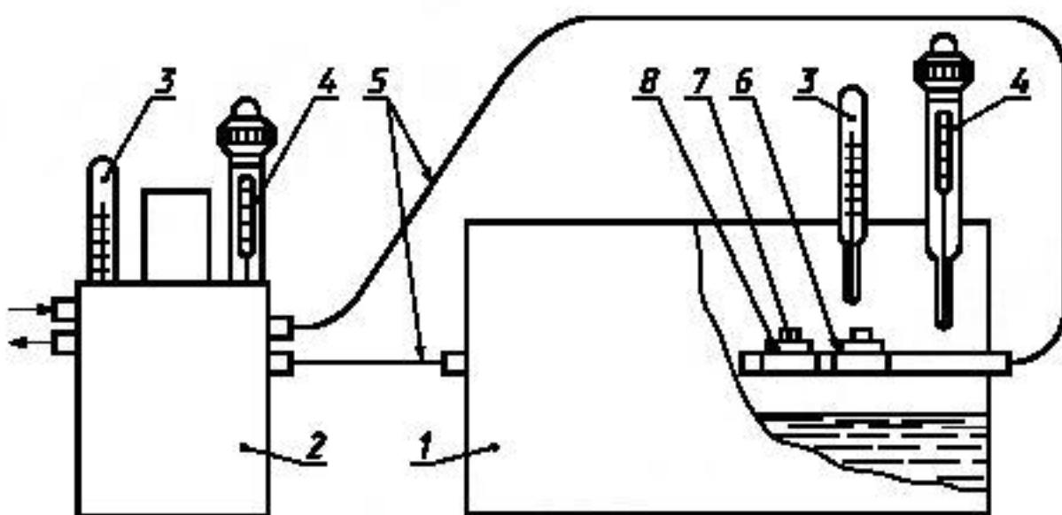
1 — камера влажности; 2 — ультратермостат; 3 — ртутные стеклянные лабораторные термометры; 4 — контактные термометры; 5 — резиновые шланги; 6 — стеклянная ячейка; 7 — медная пластина; 8 — стальня пластина
