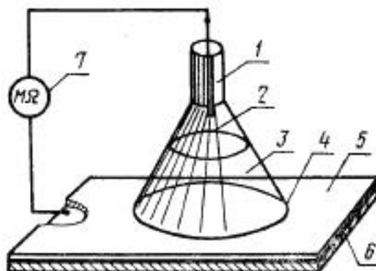
1—стеклянная воронка; 2—платиновая проволока; 3—агрессивная среда; 4—замазка; 5—покрытие; 6—металлическая пластинка; 7—термометр МММ-4.
