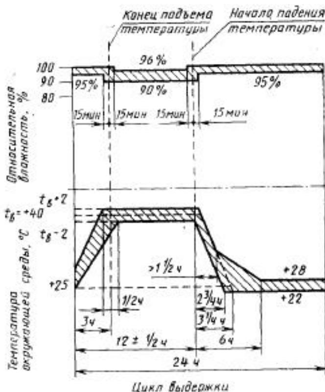
Температуру в камере понижают до  $(25 \pm 3)^\circ\text{C}$  в течение 3—6 ч при относительной влажности не менее 95%, за исключением первых 15 мин, когда она должна быть не менее 90%. Скорость снижения температуры в течение первых 1,5 ч должна быть такова, что если бы температура снижалась с этой скоростью до  $(25 \pm 3)^\circ\text{C}$ , указанная температура могла бы быть достигнута за  $3 \text{ ч} \pm 15 \text{ мин}$ .
