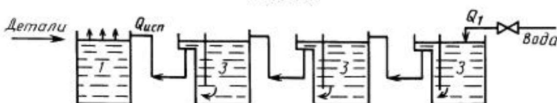
1, 2 и 3 — ванны рабочие, улавливания и промывки; Q<sub>исп</sub> — потери рабочего раствора на испарение; Q<sub>1</sub>, Q<sub>2</sub> — расчетный расход воды, лм<sup>3</sup>/ч
