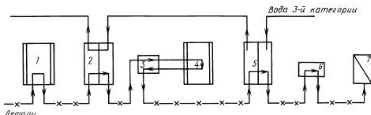
1 — ванна активации; 2, 5 — ванны промывки; 3 — ванна улавливания с водой 3-й категории; 4 — ванна нанесения покрытий; 6 — обдув сжатым воздухом или центрифугирование; 7 — сушка (термосушка)
