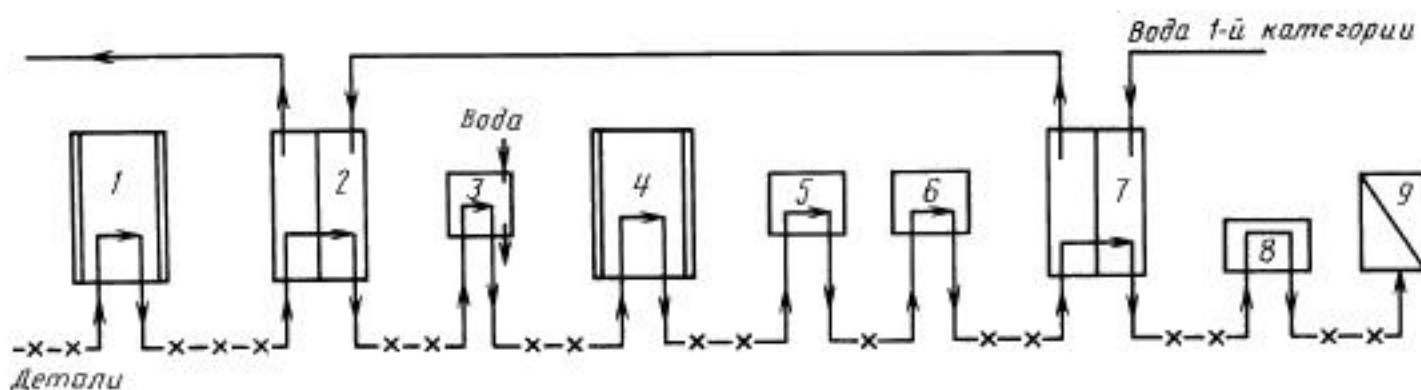
1 — ванна активации; 2, 7 — ванны промывки; 3 — ванна финишной промывки водой 3-й категории (непроточная или циркулирующая); 4 — ванна нанесения покрытий драгметаллами; 5, 6 — ванны-ловушки с водой 3-й категории; 8 — обдув сжатым воздухом или центрифугирование; 9 — термосушка
