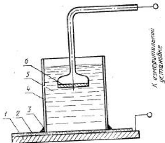
1 — металлический образец; 2 — испытуемое покрытие; 3 — уплотнительная замазка; 4 — волнистый стеклянный цилиндр; 5 — раствор хлористого натрия; 6 — платиновый электрод
