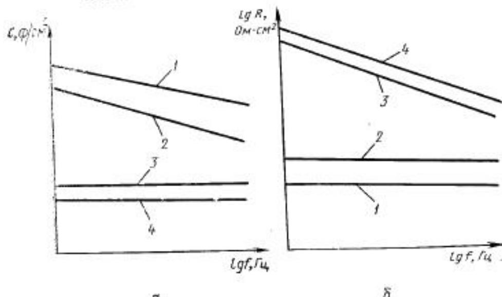
а — зависимость емкости от частоты переменного тока; б — зависимость сопротивления от частоты переменного тока; 1, 2 — покрытия не обладают защитной способностью; 3, 4 — покрытия обладают защитной способностью.
