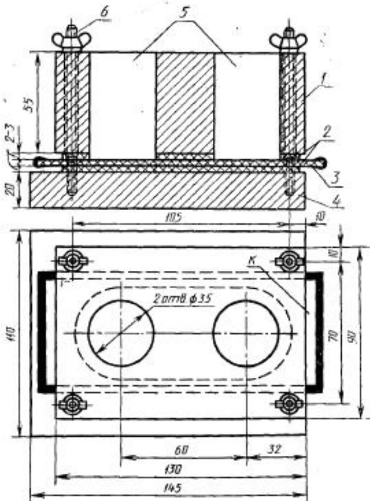
1 — брусков из оргстекла; 2 — два слоя химически стойкой резины по ГОСТ 7338; 3 — образец; 4 — подставка из текстолита или оргстекла; 5 — полые стеклянные цилиндры; 6 — шпиндель М-5 (4 шт.) длиной 90 мм; К — защищенный от покрытия участок образца
