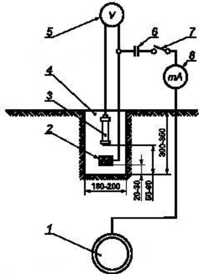
1 — трубопровод; 2 — датчик потенциала; 3 — переносной медно-сульфатный электрод сравнения; 4 — шурф; 5 — вольтметр; 6 — конденсатор; 7 — выключатель; 8 — миллиамперметр переменного тока
