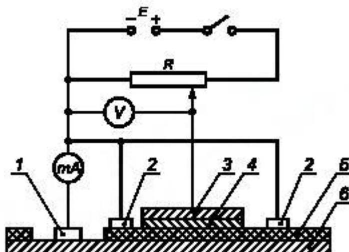
1 — контакт с трубой; 2 — экранирующие кольцевые электрод-бандажи; 3 — кольцевой электрод-бандаж; 4 — тканевое полотно; 5 — изоляционное покрытие трубы; 6 — стенка трубы; E — источник постоянного тока; R — потенциометр; V — высокоомный вольтметр; mA — миллиамперметр
