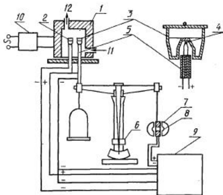
1 — термокамера; 2 — тигель с инертным веществом; 3 — тигель с пробой; 4 — термопара; 5 — керамическая трубка; 6 — весы; 7 — катушка; 8 — магнит; 9 — регистрирующий блок с пневматическим устройством; 10 — блок питания и управления нагревом печи; 11 — вход газа (для вакуумирования); 12 — отвод газообразных продуктов
