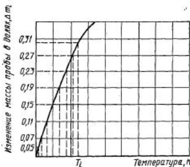
6.3. Для получения кинетических параметров  $E$  и  $K$  обработку результатов, полученных по п. 6.2 для каждого из процессов и для каждой из скоростей нагрева, проводят по формуле
