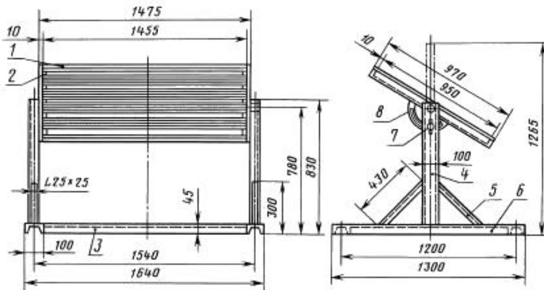
1 — продольная рейка рамы ( $40 \times 40 \times 1455$  мм, 10 шт.); 2 — поперечная рейка рамы ( $40 \times 40 \times 950$  мм, 2 шт.); 3 — швеллер (№ 10, длина 1440 мм, 2 шт.); 4 — швеллер (№ 10, длина 784 мм, 2 шт.); 5 — связь наклонная (прокат угловой равнобокий, длина 430 мм, 4 шт.); 6 — швеллер (№ 10, длина 1300 мм, 2 шт.); 7 — стопорный болт; 8 — дуга
