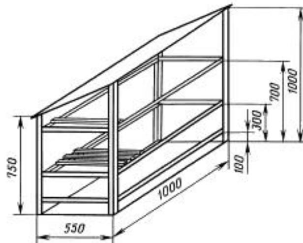
Стенд состоит из каркаса и укрепленных в нем рам, на которые кладут съемные планки для крепления образцов. Каркас изготовляют из стального уголка и окрашивают.
