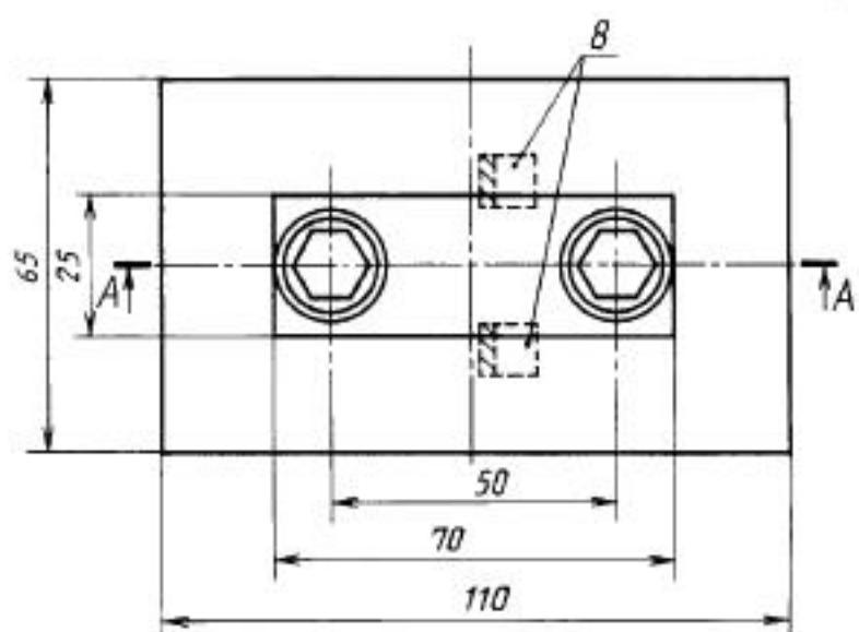
1 — анодная пластина; 2 — катодная пластина; 3 — болт 8 × 40 мм; 4 — шайба толщиной 1 мм, диаметром 16 мм; 5 — изолирующая шайба толщиной 1—3 мм, диаметром 18—20 мм; 6 — изолирующая втулка; 7 — гайка; 8 — шлиф
