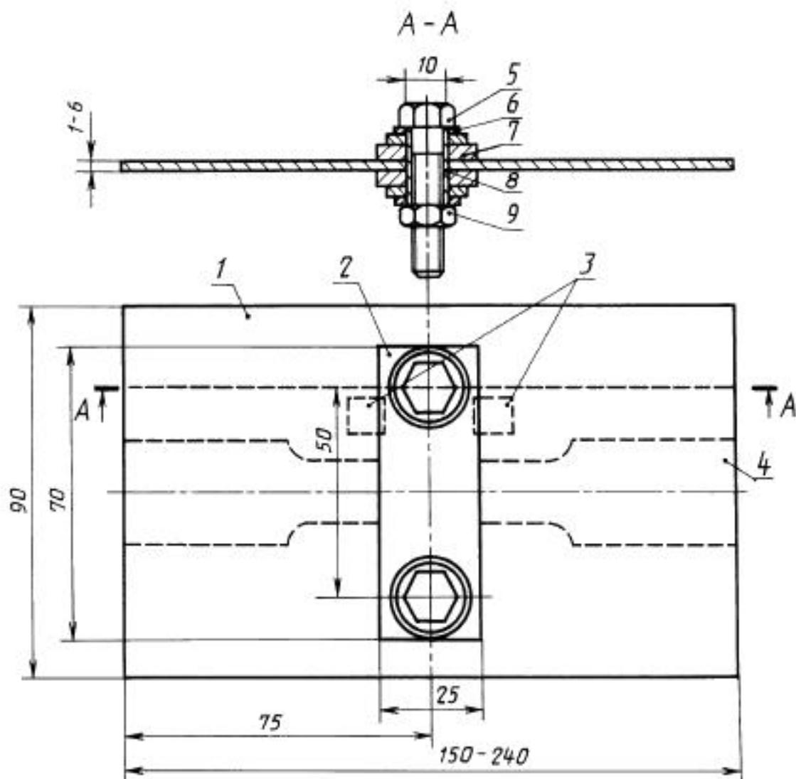
1 — анодная пластина; 2 — катодная пластина; 3 — шлиф; 4 — образец, испытуемый на растяжение; 5 — болт 8 × 40 мм;
