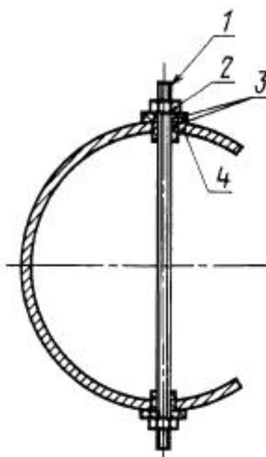
1 — шпилька; 2 — гайка; 3 — прокладка; 4 — образец
