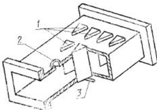
1 — образец; 2 — бобышка для установки термопары газового потока; 3 — упор
