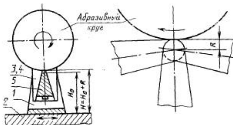
1 — опора; 2 — стол шлифовального станка; 3, 4 — полусоси; 5 — образец
