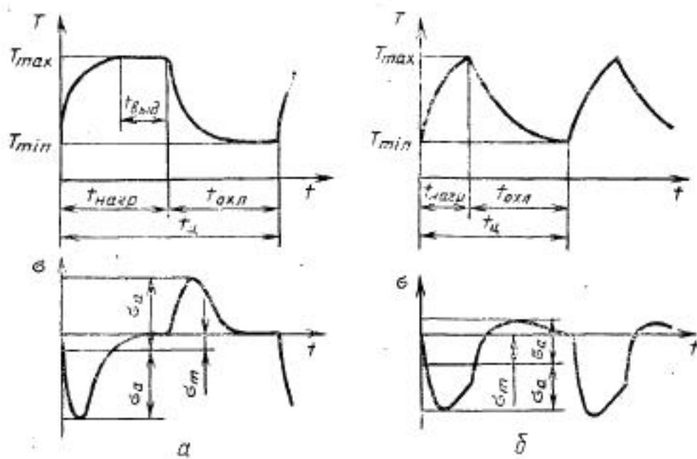
а — режим с выдержкой при максимальной и минимальной температурах; б — режим без выдержек
