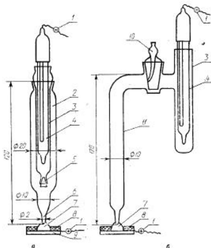
1 — контактные провода; 2 — сосуд с испытательным раствором; 3 — сосуд с насыщенным раствором хлорида калия; 4 — хлорсеребряный электрод; 5 — шлифованная пробка; 6 — капилляр электрохимической ячейки; 7 — капля испытательного раствора; 8 — изолирующая пленка; 9 — испытуемый образец; 10 — край; 11 — трубка с капилляром
