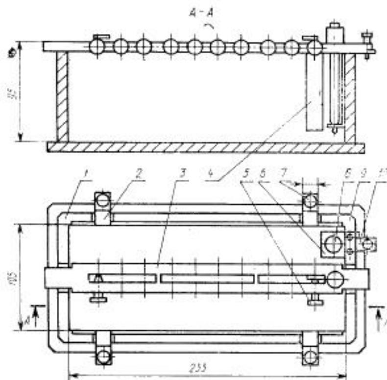
1 — корпус ячейки из органического стекла; 2 — электрод вспомогательный из стали 12X18H10T; 3 — держатель образцов из стали 12X18H10T; 4 — испытуемый образец; 5 — винт из стали 12X18H10T; 6 — планка из стали 12X18H10T; 7 — винт из стали 12X18H10T; 8 — электрод сравнения; 9 — клемма КП-1А; 10 — электрод дополнительный
