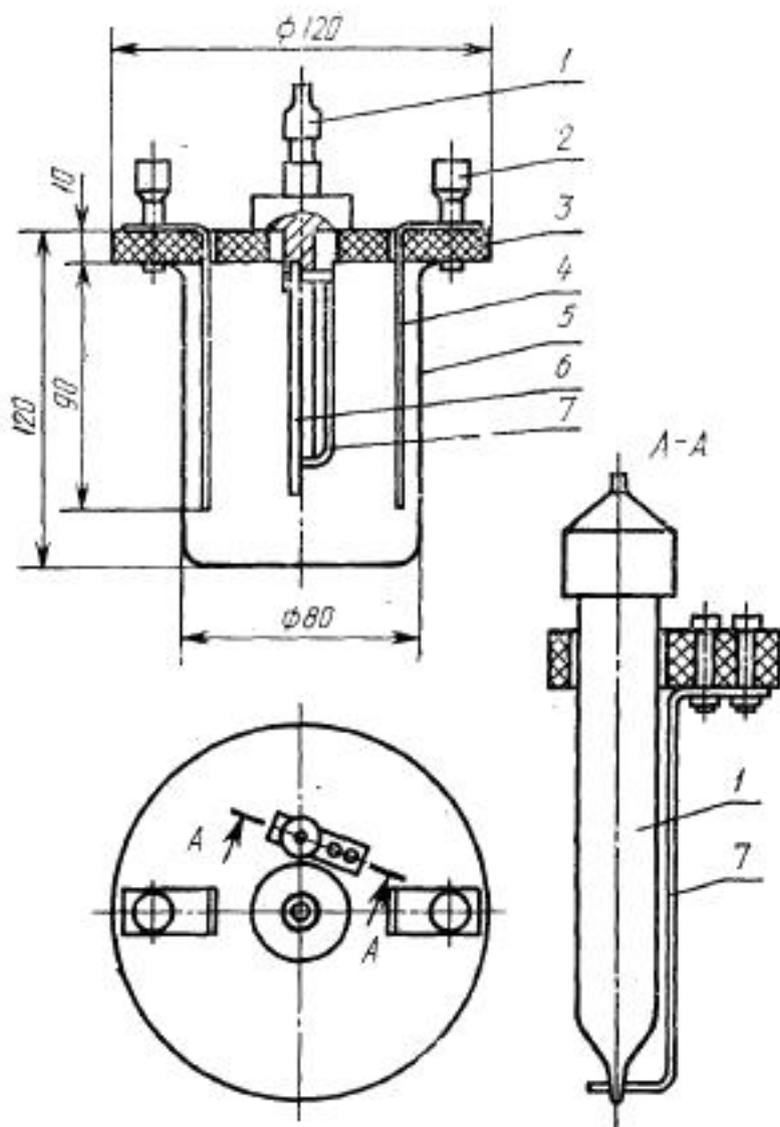
1 — электрод сравнения; 2 — клемма, 2 шт.; 3 — крышка из диэлектрического материала; 4 — вспомогательный электрод, 2 шт. из стали 12X18H10T; 5 — химический стакан; 6 — испытуемый образец; 7 — держатель электрода сравнения из стали 12X18H10T
